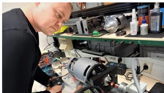
Pan elektrikář Franta Vacek při měření krouticího momentu.
